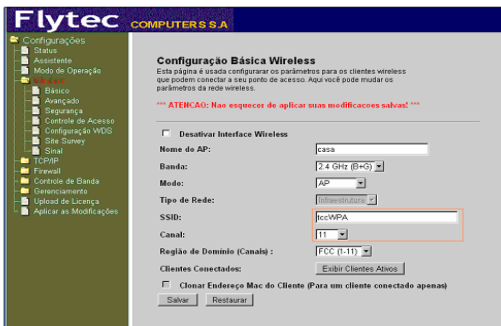
Figura 42. Configuração do AP para testes com o WPA
