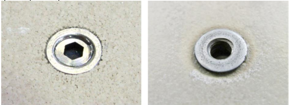
Figura 13 - Insertos antes (esquerda) e depois da etapa de queima (direita). O parafuso sem cabeça pode ser visto (à esquerda), em seguida, removido após a queima (à direita).
