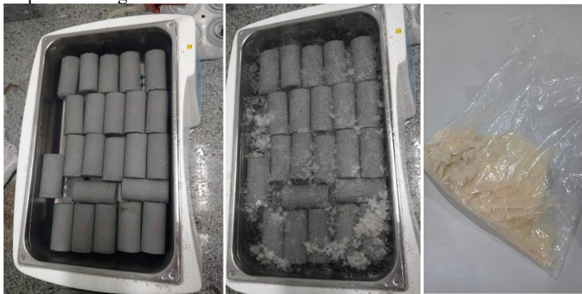
Figura 27 - Exsudação de parafina observada após a ebulição dos corpos de prova de argamassa de reboco contendo PCM.
