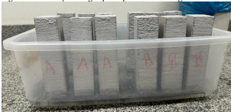
Figura 14 - Absorção de água por capilaridade das argamassas de reboco.
