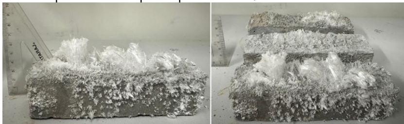
Figura 30 - Dentritos fibrosos de sódio decorrentes da recristalização de sais na superfície dos corpos de provas AcS 20%.
