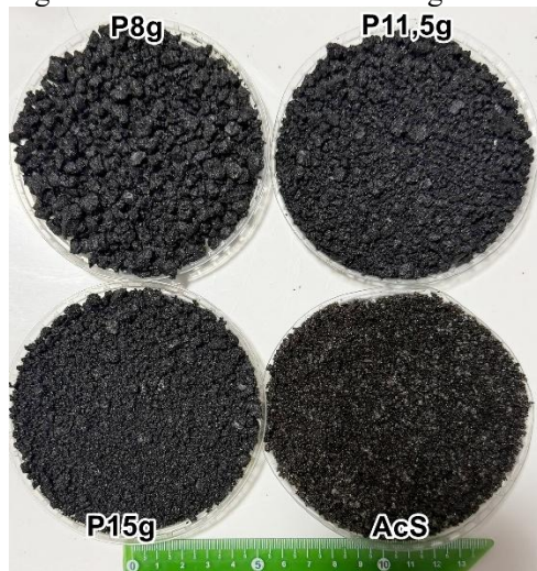
Figura 22 - PCMs utilizados na argamassa de reboco.
