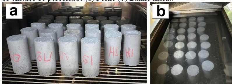
Figura 13 - Amostras dos corpos de provas de argamassa de reboco para os ensaios de porosidade (a) Forno (b) Banho maria.
