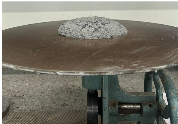
Figura 11 – Equipamento para índice de consistência realizado nas argamassas de reboco.
