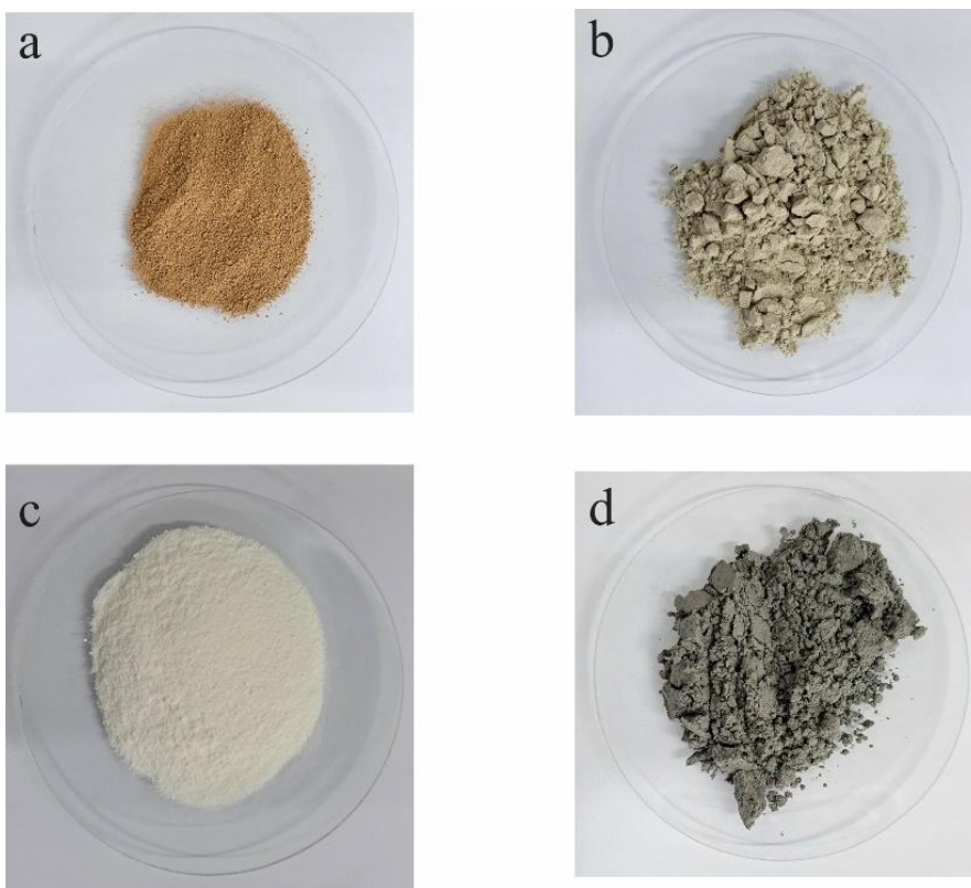
Figura 4 - Matérias-primas utilizadas na presente pesquisa: A – pó porcelânico, B – argila plástica - bentonita, C – carboximetilcelulose (CMC) e D – calcário.
