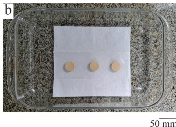
Figura 16 - Corpos de prova submetidos a caracterização acústica: A – corpos de prova cilíndricos (Ø 26 mm) REF, queimados na temperatura 1140 °C, B – corpos de prova cilíndricos (Ø 26 mm) F50, queimados na temperatura 1140 °C.
