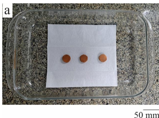
Figura 16 - Corpos de prova submetidos a caracterização acústica: A – corpos de prova cilíndricos (Ø 26 mm) REF, queimados na temperatura 1140 °C, B – corpos de prova cilíndricos (Ø 26 mm) F50, queimados na temperatura 1140 °C.
