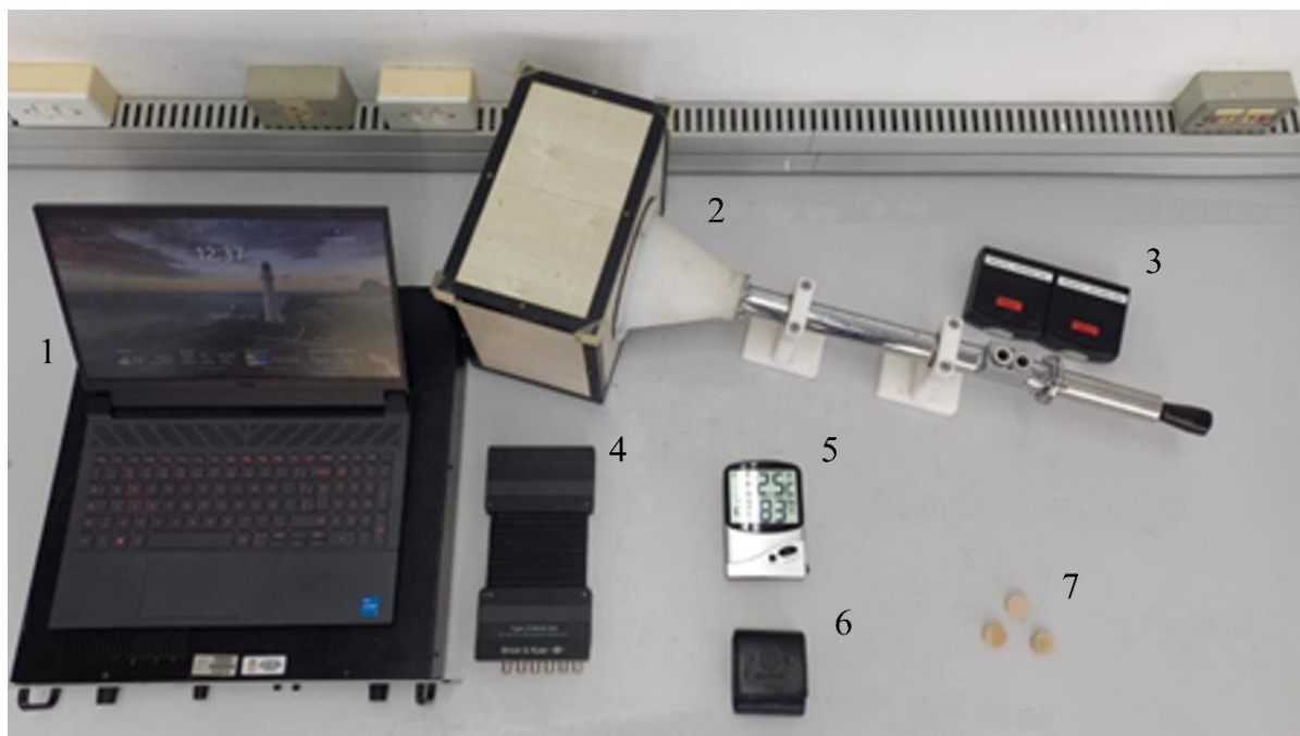
Figura 15 - Setup experimental utilizado nos ensaios de absorção sonora.
