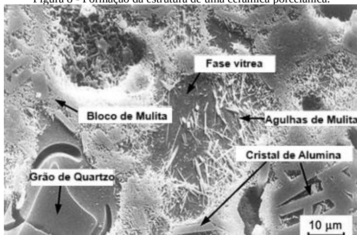
Figura 8 - Formação da estrutura de uma cerâmica porcelânica.
