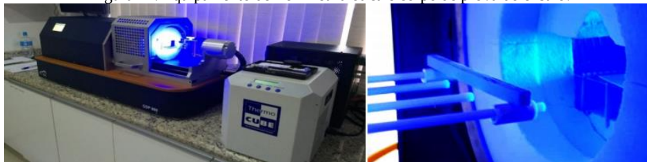
Figura 12. Equipamento de fleximetria ótica e corpo de prova do ensaio.
