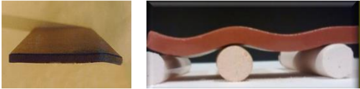
Figura 9 - Placas cerâmicas com deformação pirolástica
