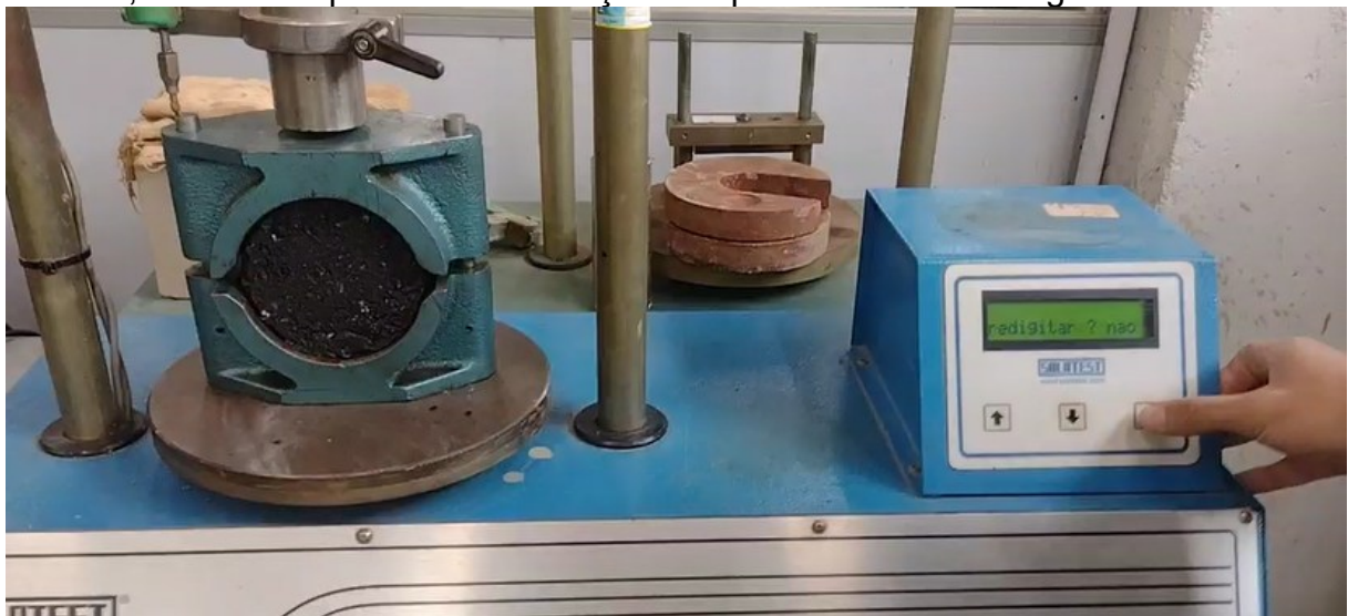
Figura 20 – Prensa Marshall utilizada para a realização do ensaio de estabilidade e fluência, necessário para a determinação dos parâmetros de dosagem.
