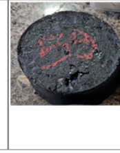
Figura 45 – Ficha de resultado da dosagem do Grupo 13, produzido com 100% de inclusão de RAP na mistura exclusivamente na parcela de agregado miúdo.
