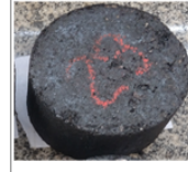
Figura 38 – Ficha de resultado da dosagem do Grupo 07, produzido com agregado miúdo de pó de pedra de origem granítica e 50% de inclusão de RAP na mistura.
