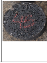
Figura 39 – Ficha de resultado da dosagem do Grupo 11, produzido com 100% de inclusão de RAP na mistura.
