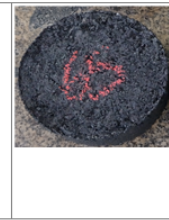
Figura 46 – Ficha de resultado da dosagem do Grupo 02, produzido com agregado miúdo de pó de pedra de origem basáltica e 0% de inclusão de RAP na mistura.
