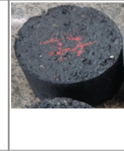
Figura 48 – Ficha de resultado da dosagem do Grupo 08, produzido com agregado miúdo de pó de pedra de origem basáltica e 50% de inclusão de RAP na mistura.
