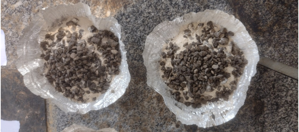
Figura 17 – Amostras separadas conforme dosagem para a permanência em estufa visando a produção de corpos de prova necessários aos ensaios.
