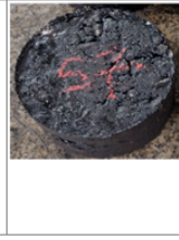
Figura 45 – Ficha de resultado da dosagem do Grupo 13, produzido com 100% de inclusão de RAP na mistura exclusivamente na parcela de agregado miúdo.
