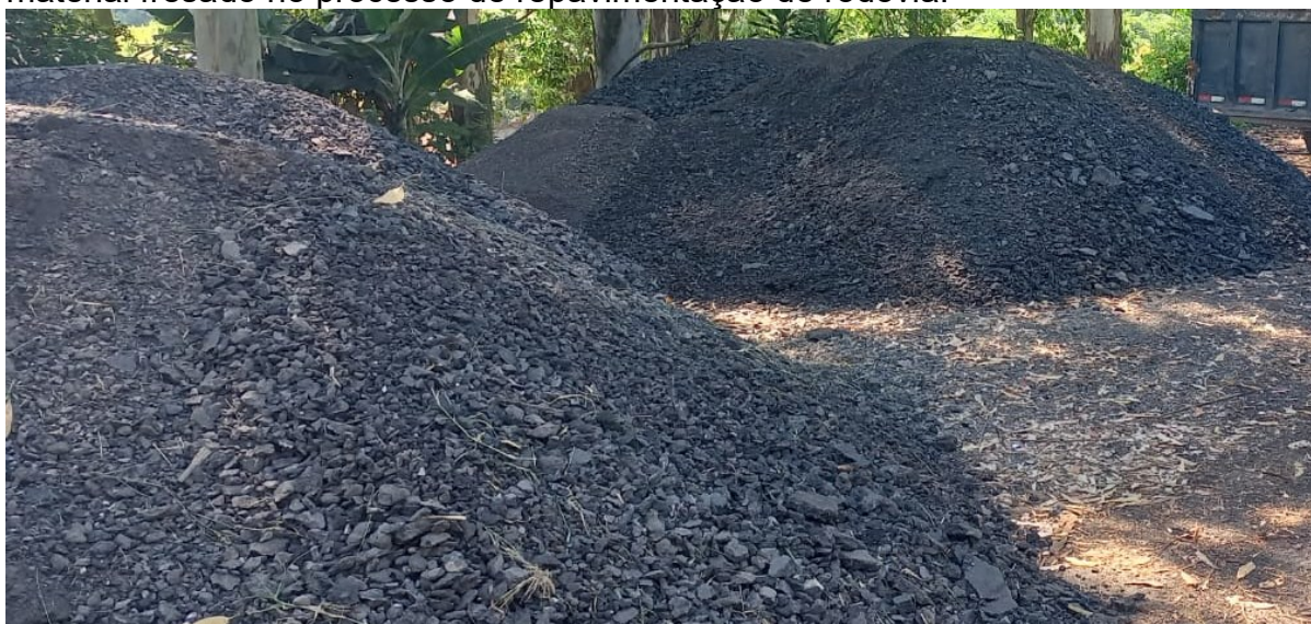
Figura 4 – Registro fotográfico de um local utilizado como ponto de bota-fora para o material fresado no processo de repavimentação de rodovia.
