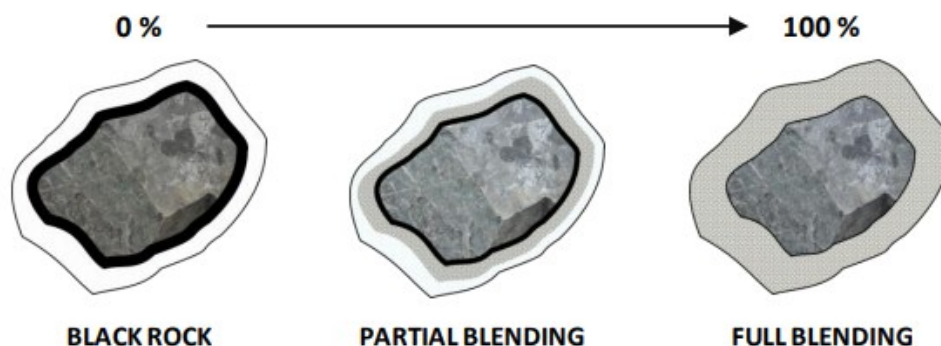
Figura 5 – Representação de possíveis cenários para a interação entre ligantes betuminosos na valorização de RAP (da esquerda para a direita): sem qualquer tipo de interação - black rock ; interação parcial – partial blending e interação total - full blending .
