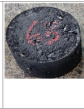
Figura 46 – Ficha de resultado da dosagem do Grupo 02, produzido com agregado miúdo de pó de pedra de origem basáltica e 0% de inclusão de RAP na mistura.
