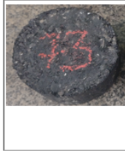
Figura 48 – Ficha de resultado da dosagem do Grupo 08, produzido com agregado miúdo de pó de pedra de origem basáltica e 50% de inclusão de RAP na mistura.
