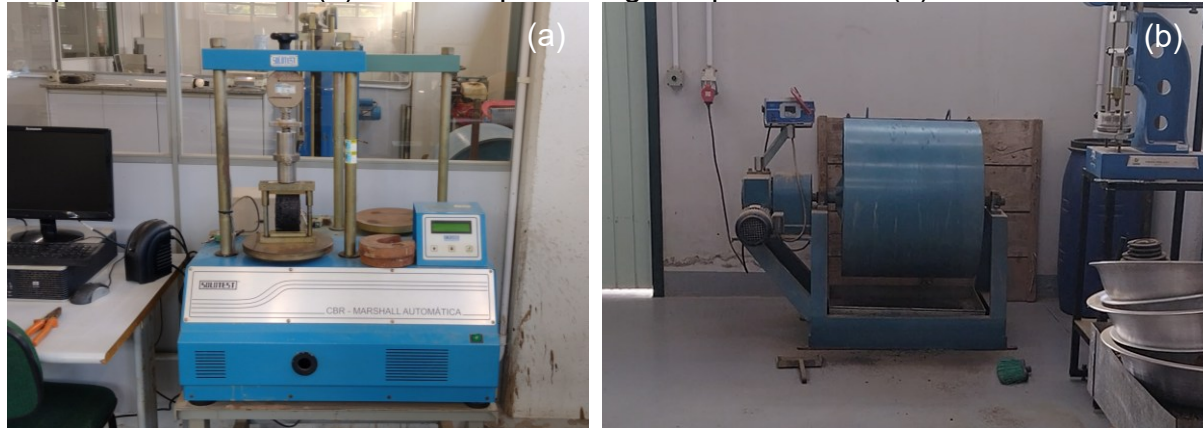
Figura 21 – Equipamentos para a realização de ensaio de resistência à tração por compressão diametral (a) e tambor para desgaste por abrasão (b).
