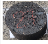
Figura 38 – Ficha de resultado da dosagem do Grupo 07, produzido com agregado miúdo de pó de pedra de origem granítica e 50% de inclusão de RAP na mistura.
