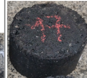
Figura 40 – Ficha de resultado da dosagem do Grupo 05, produzido com agregado miúdo de pó de pedra de origem granítica e 25% de inclusão de RAP na mistura exclusivamente na parcela de agregado graúdo.
