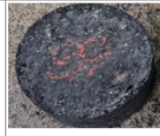
Figura 47 – Ficha de resultado da dosagem do Grupo 04, produzido com agregado miúdo de pó de pedra de origem basáltica e 25% de inclusão de RAP na mistura.
