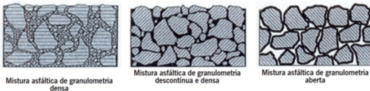
Figura 2 – Ilustração das diferentes características de graduações granulométricas para agregados em misturas asfálticas.
