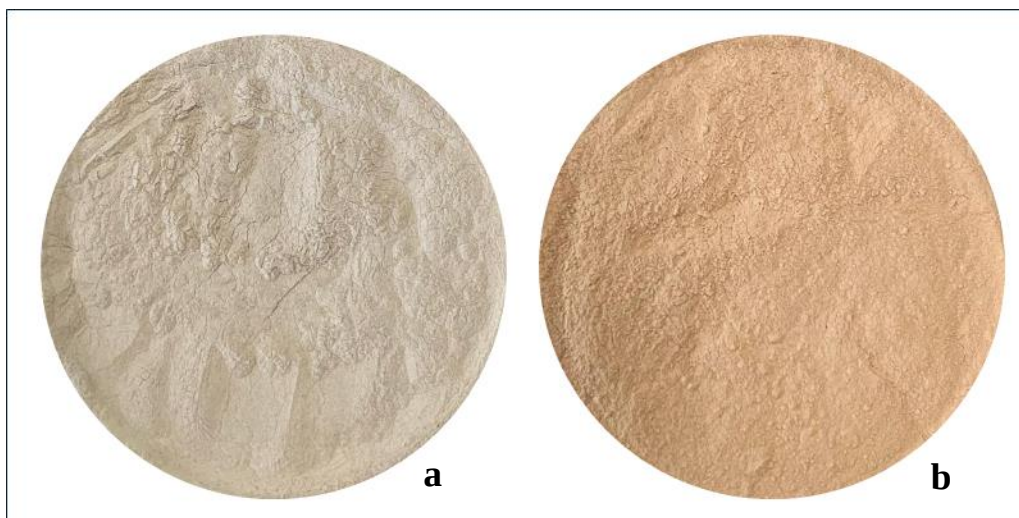
Figura 7. Aparência visual das amostras tratada termicamente a 900 °C, FRT-A (a) e FRT-B (b).
