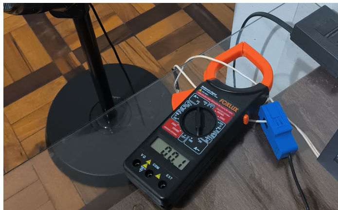
Figura 8 - Leitura de corrente de um ventilador
