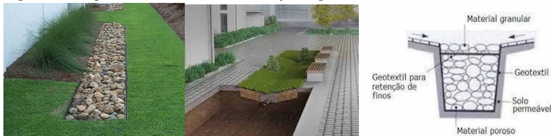
Figura 5.6 - Tipos de trincheira de biorretenção; figura 5.7- corte transversal de trincheira
