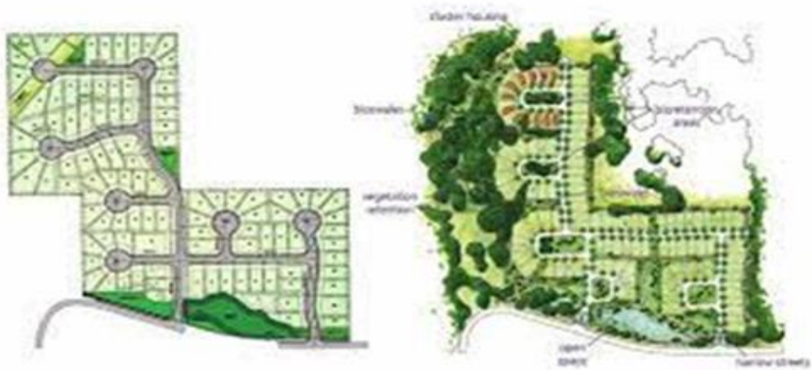
Figura 5.16 - Comparação entre design tradicional e design que observa os objetivos de LID
