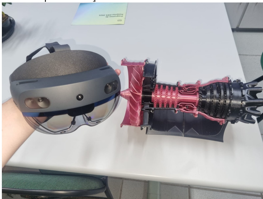
Figura 2 - Setup da validação com HoloLens 2 e modelo físico do motor
