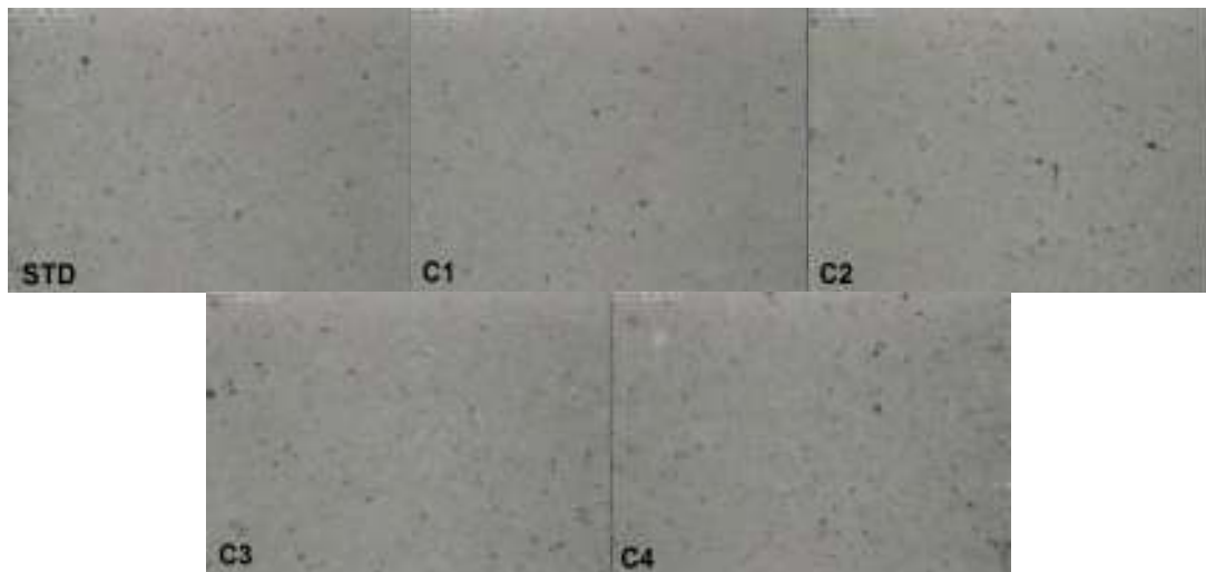
Figura 05. Micrografias superficiais das formulações STD, C1, C2, C3 e C4 com aumento de 20x após sinterização em forno industrial.
