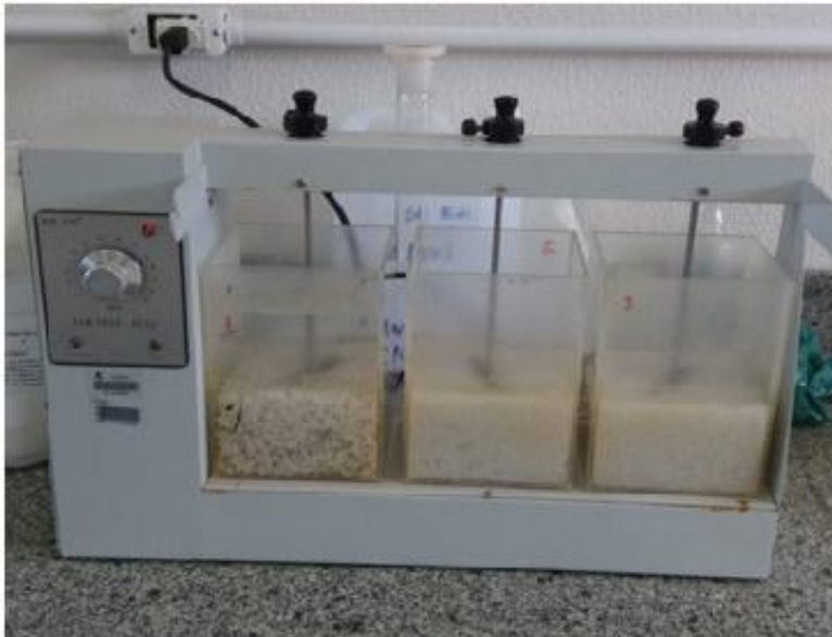
Figura 17– Ensaio em Jartest com efluente coletado no dia 15 de setembro.
