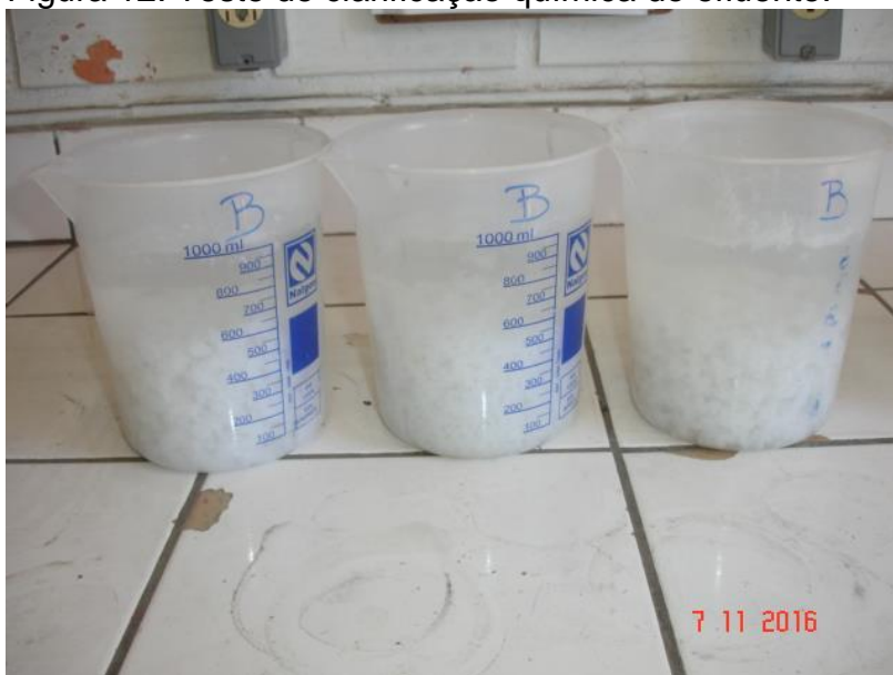
Figura 12: Teste de clarificação química do efluente.
