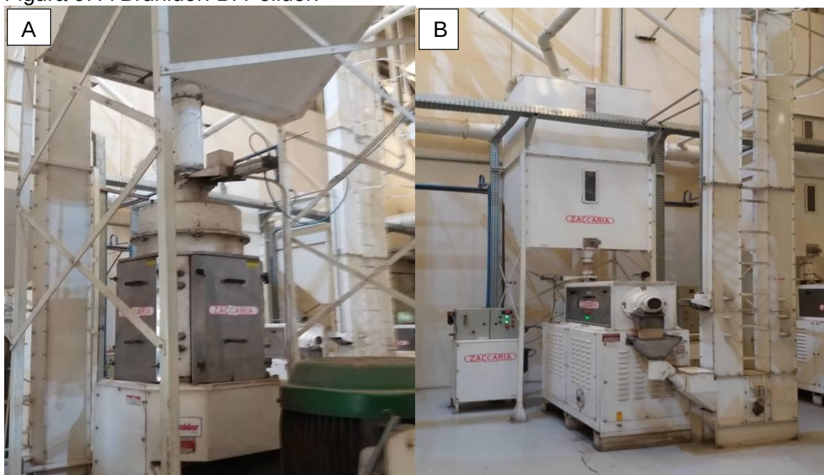
Figura 9: A Brunidor. B: Polidor.
