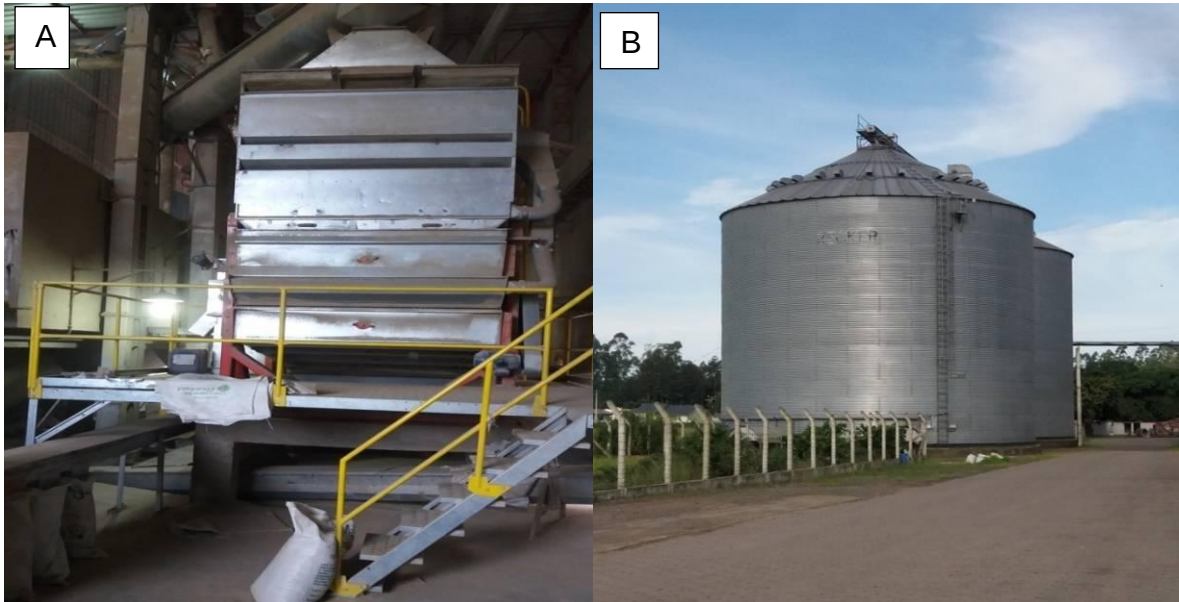
Figura 4: A: Limpeza Primária: Peneira. B: Silos de armazenamento de arroz em casca.
