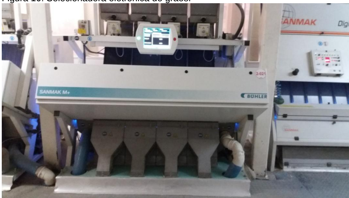
Figura 10: Selecionadora eletrônica de grãos.
