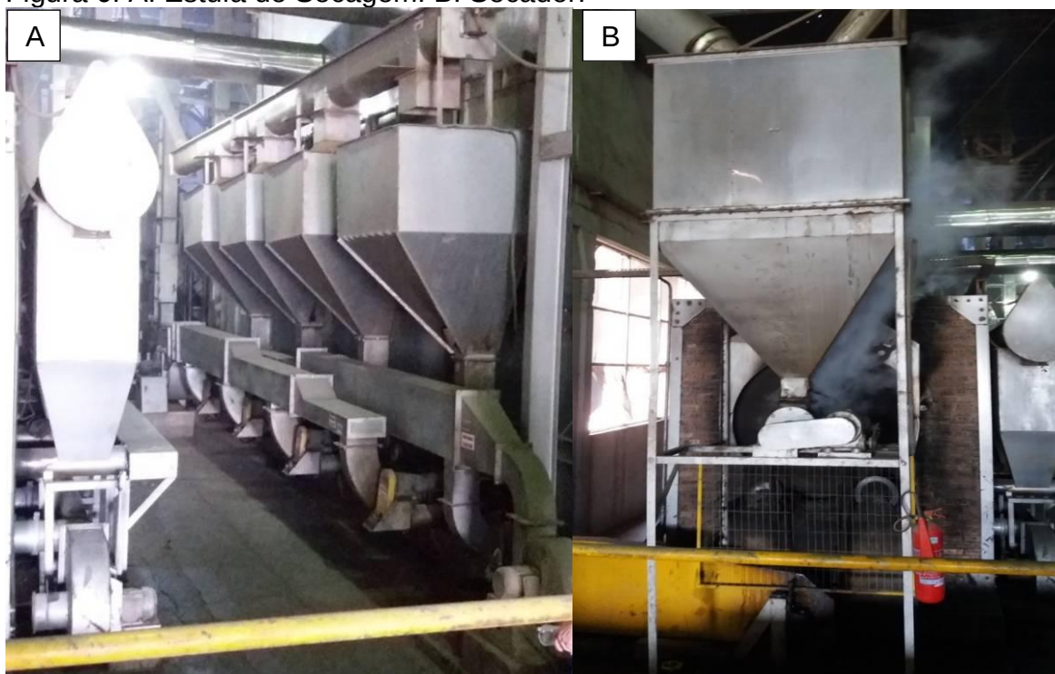
Figura 6: A: Estufa de Secagem. B: Secador.
