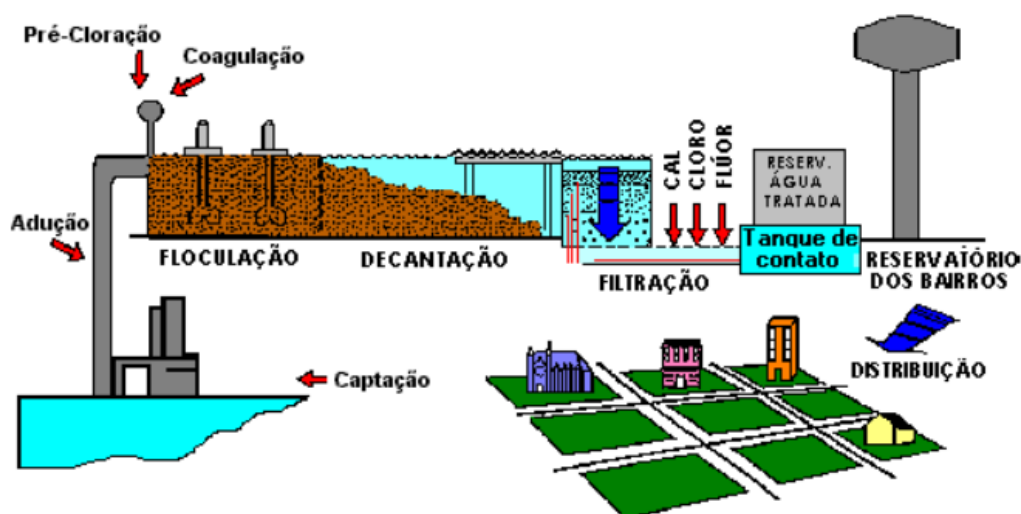
Figura 01 – Etapas do tratamento convencional de água.
