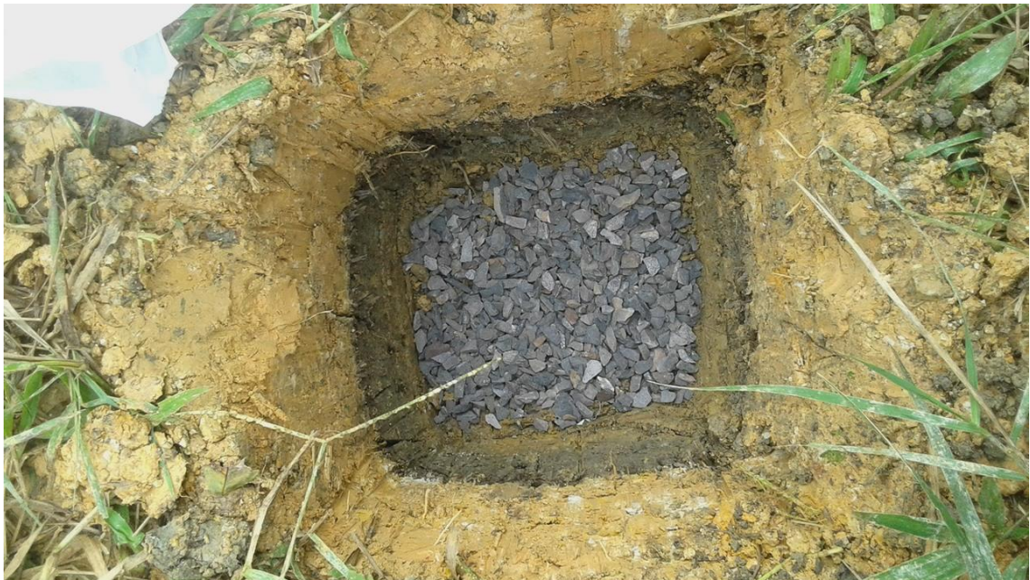
Figura 24 – Realização do teste de percolação na área.
