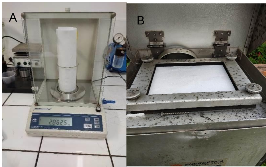
Figura 12: A - Pesagem do filtro. B - Instalação do filtro para monitoramento.
