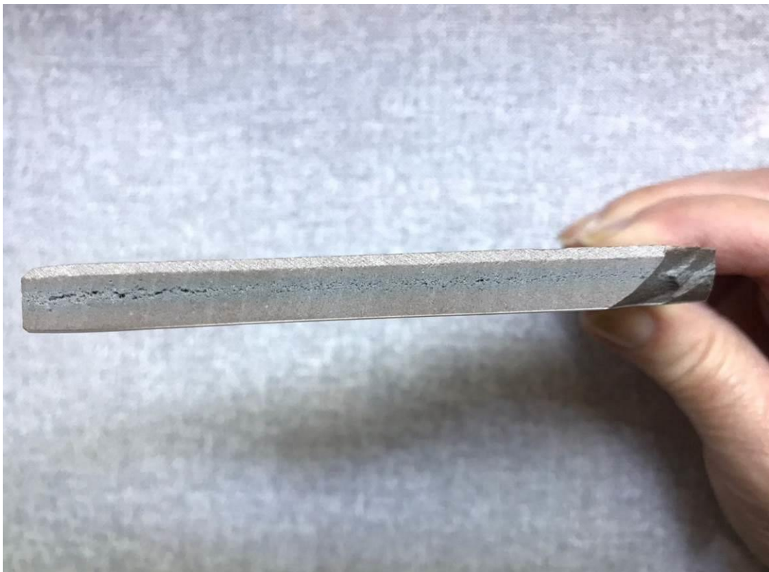
Figura 2 - Placa cerâmica com coração negro
