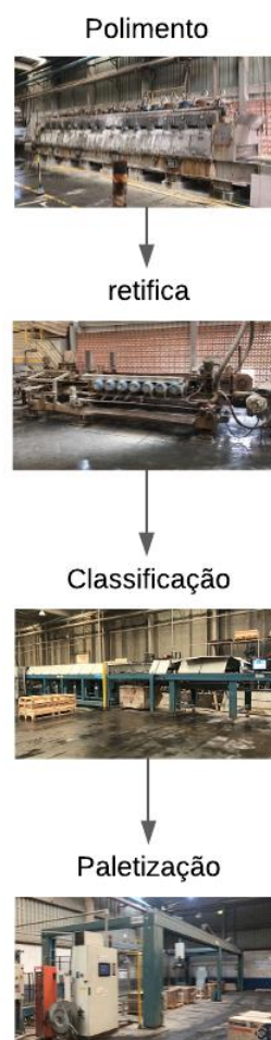
Figura 8 – Processo produtivo de acabamento
