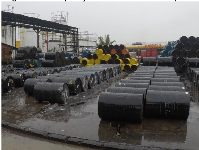
Figura 19 - Disposição dos tambores sob piso impermeável
