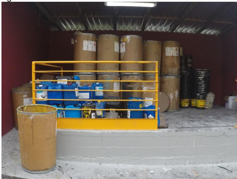
Figura 12 - Armazenamento dos resíduos contaminados
