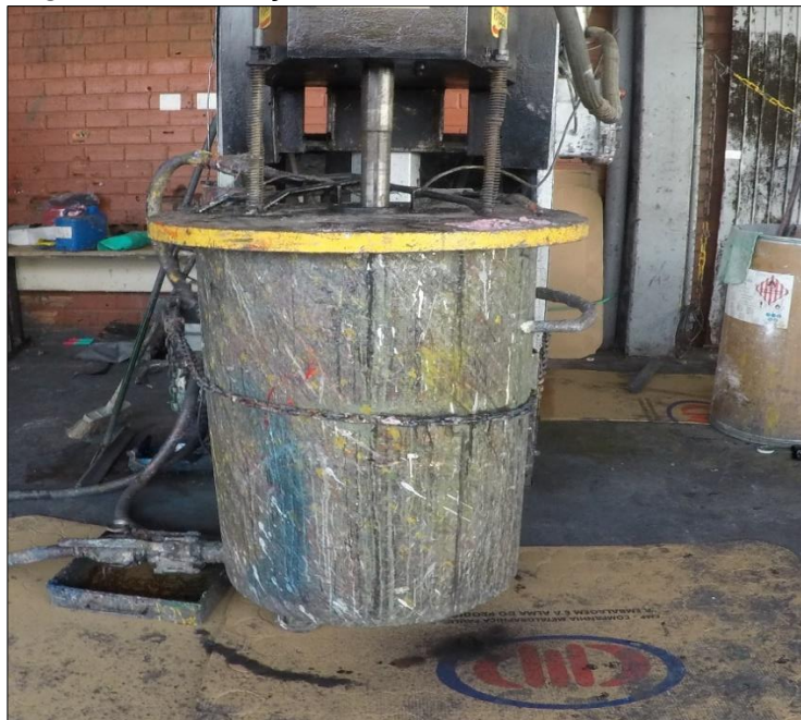
Figura 30 - Lavagem de tachos automática
