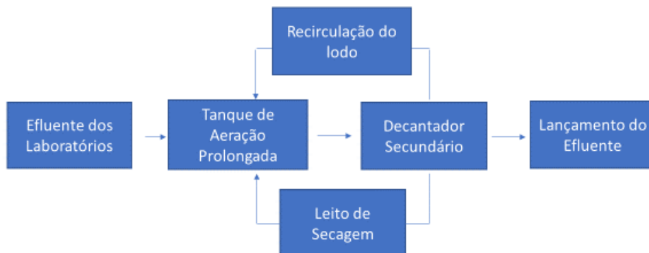
Figura 19 – Fluxograma da estação de tratamento 2.
