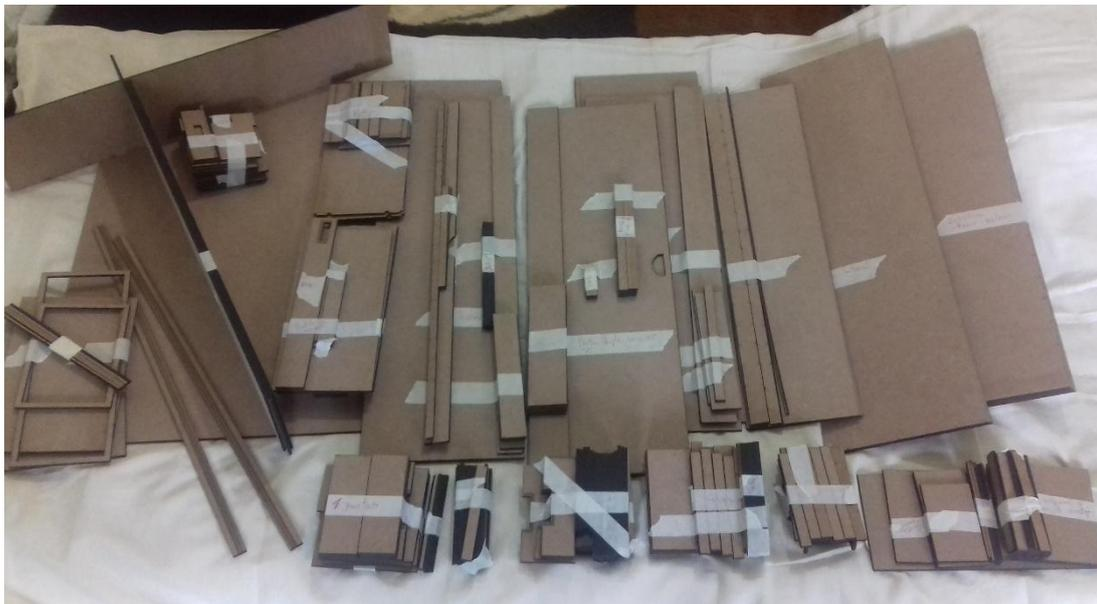
Figura 44: Separação das peças do modelo cortadas a laser
