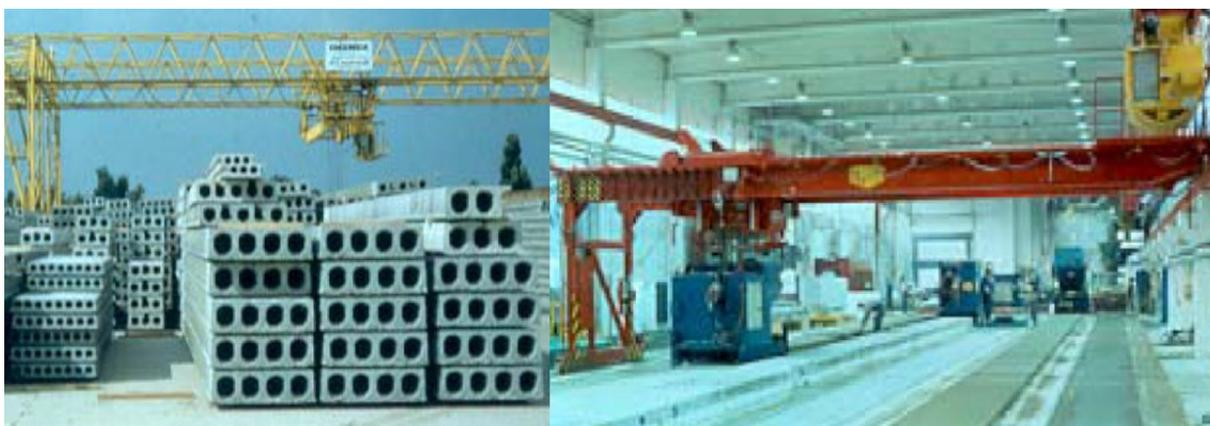
Figura 1 - Área de Armazenagem das lajes Alveolares e Pista de concretagem.
