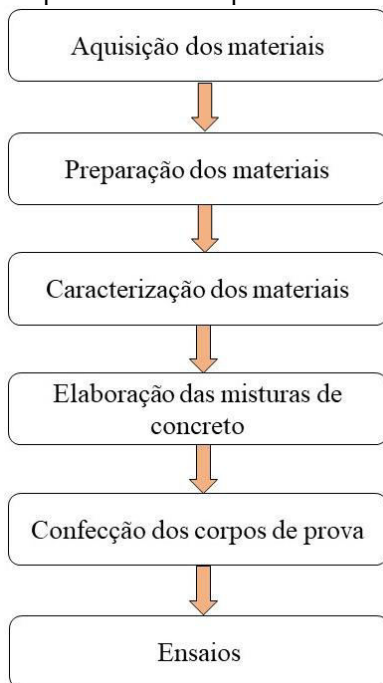
Figura 6 - Fluxograma representativo das principais etapas do procedimento experimental.
