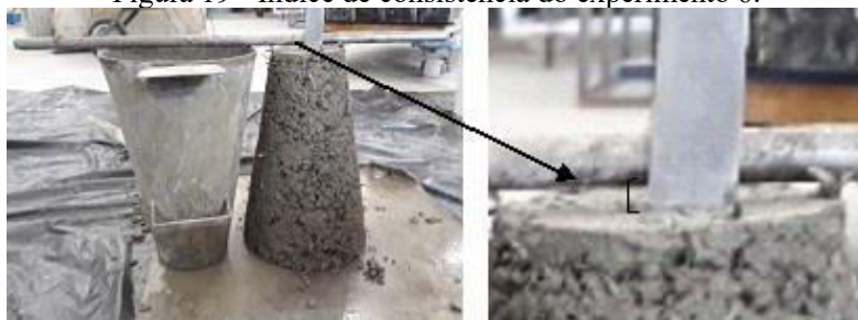
Figura 19 - Índice de consistência do experimento 6.
