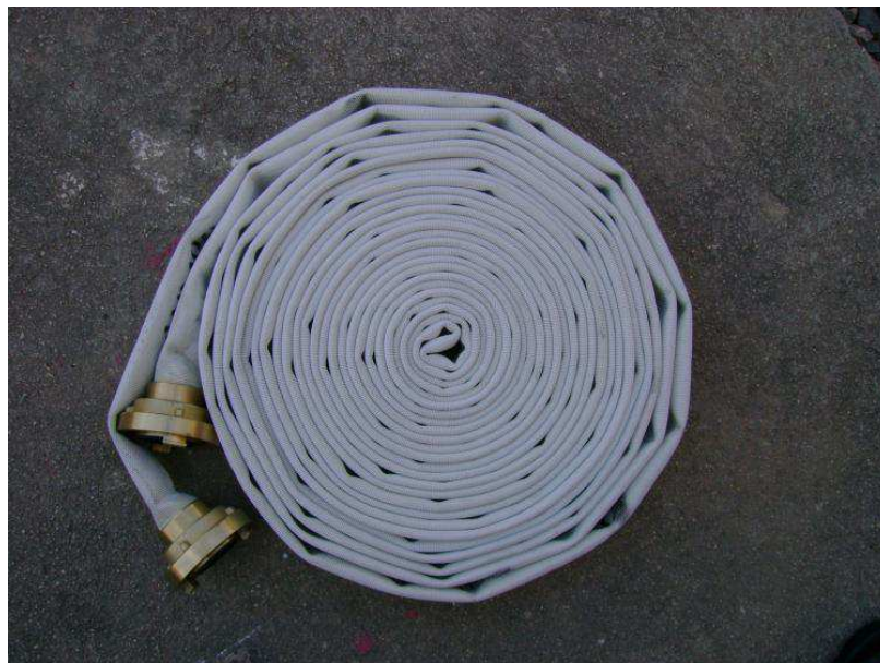
Figura 9 – Mangueira de combate a incêndio tipo 1 (38 mm) Fonte: Zanin (2008)
