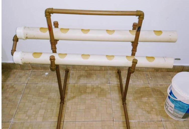
Figura 37 - Montagem Jardim Hidropônico
