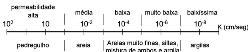
Figura 5. Intervalos de variação de coeficiente de permeabilidade (Fonte: Cavalcante e Casagrande, 2006)
