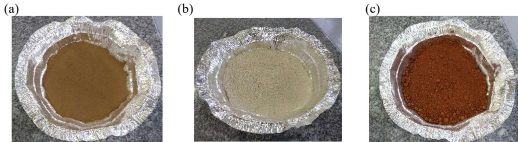
Figura 1. Materiais utilizados (a) lodo de ETA seco e moído (b) bentonita sódica (c) solo
