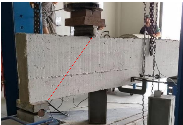
Figura 9: Ensaio de cisalhamento da viga VX403
