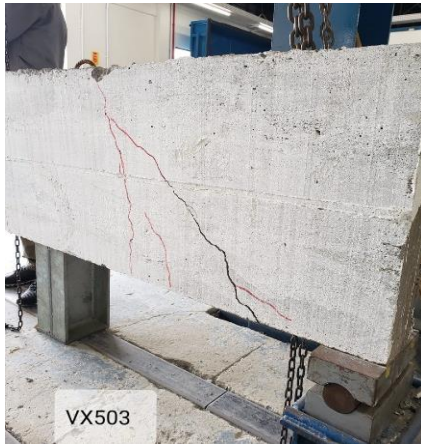
Figura 10: Aspecto de uma das vigas após a realização do ensaio.
