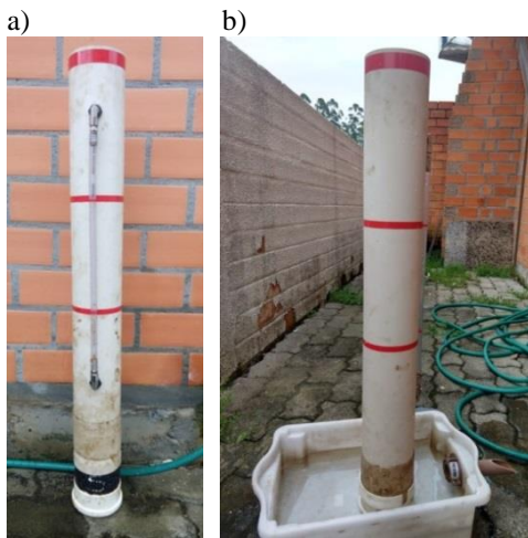
Figura 4. Realização de ensaios: (a) Permeabilidade horizontal, (b) Permeabilidade vertical.
