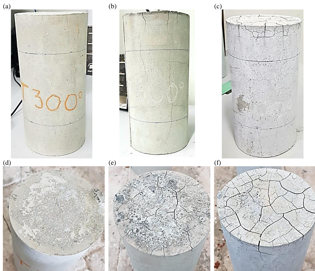
Figura 6. Graute expostos a altas temperaturas, (a) graute após exposição a 300°C, (b) graute após exposição a 600°C, (c) graute após exposição a 900°C, (d) vista superior do graute exposto a 300°C, (e) vista superior do graute exposto a 600°C e (f) vista superior do graute exposto a 900°C.
