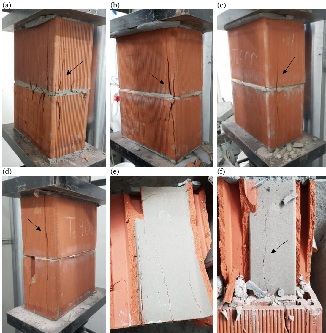
Figura 8. Ensaio de resistência à compressão, (a) prisma REF (b) prisma T 300°C (c) prisma T 600°C (d) prisma T 900°C, (e) parede do bloco e (f) graute no interior do prisma.
