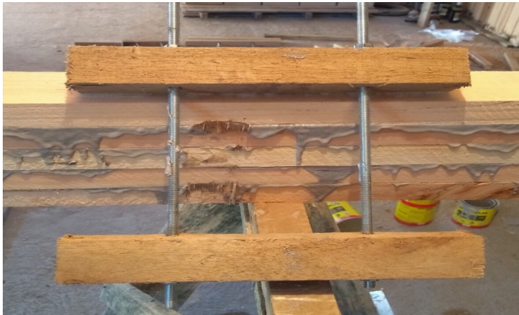
Figura 6. Aparato utilizado para prensagem do MLC.
