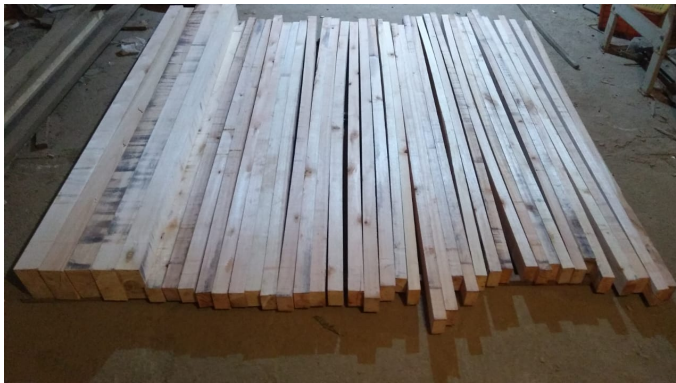
Figura 3. Lâminas utilizadas para a confecção das vigas.
