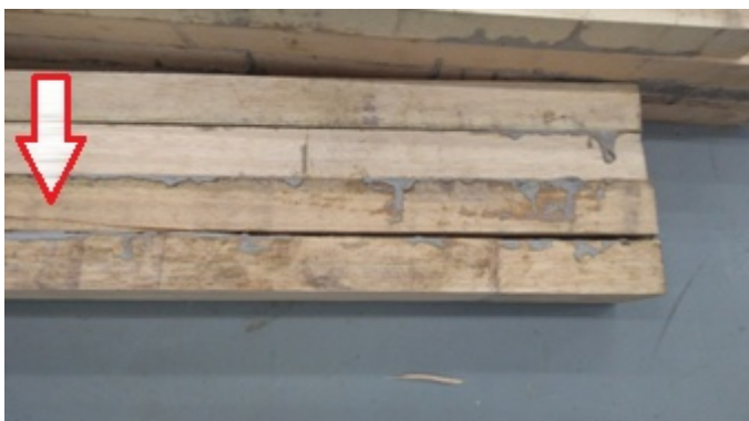
Figura 8. Viga 4L-5 rompida por cisalhamento.
