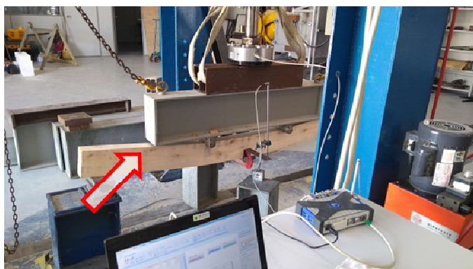
Figura 11. Ensaio de flexão a 4 pontos com a viga 1-L1.
