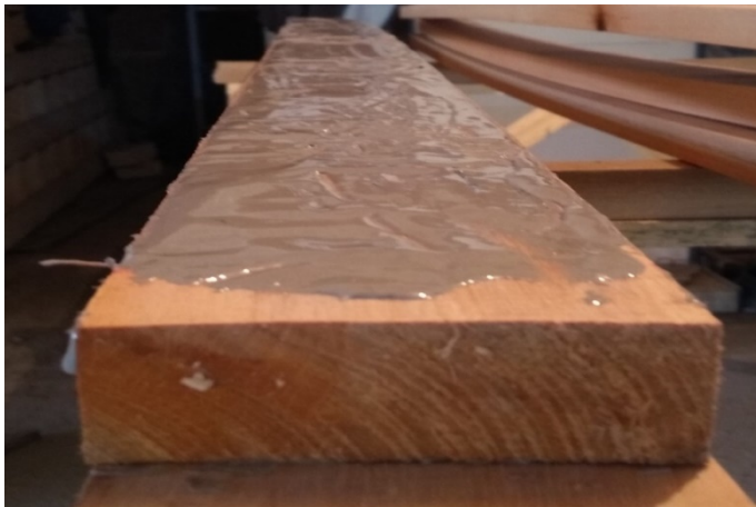
Figura 4. Adesivo epóxi aplicado sobre a superfície da lâmina.
