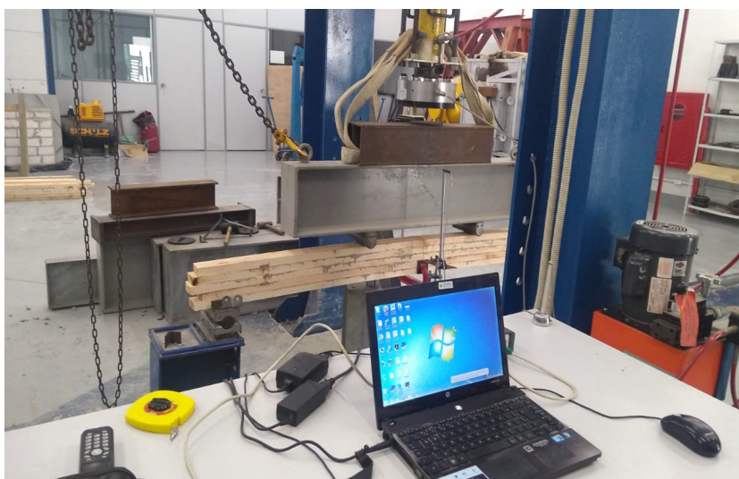
Figura 7. Ensaio de flexão a 4 pontos.
