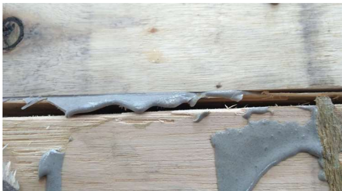
Figura 12. Arrancamento da lasca de madeira paralela à linha de adesivo.
