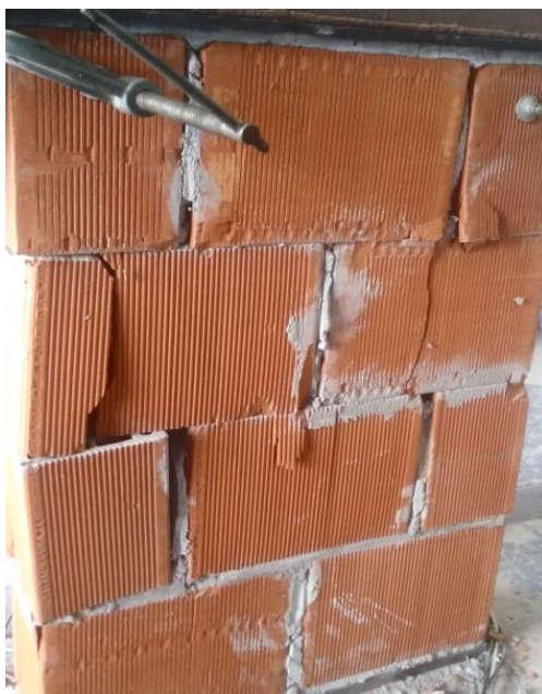
Figura 10. Pequena parede após ensaio de ruptura.
