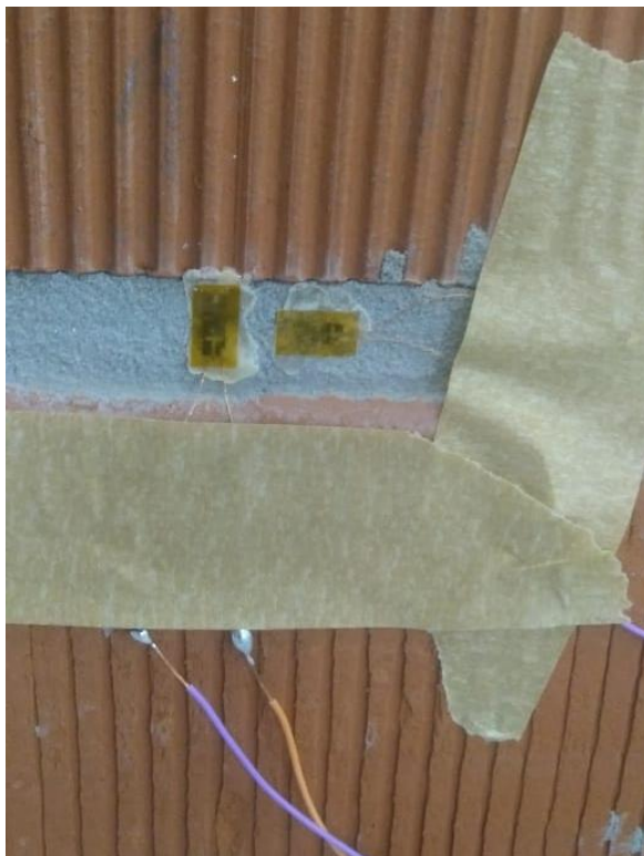
Figura 5: Strain Gages colados na direção horizontal e vertical
