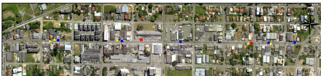
Legenda: Amarelo: Sarjeta rasa; Azul: Baixa declividade; Vermelho: Boca de lobo entupida. Figura 5. Localização dos problemas encontrados na situação atual da Avenida.
