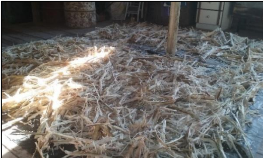
Figura 17 - Bagaço da cana-de-açúcar armazenado em local coberto após lavagem inicial.
