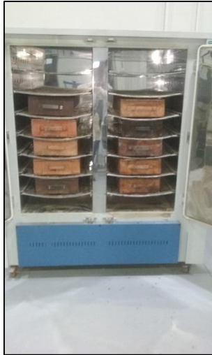
Figura 22 - Agregados miúdos e graúdo submetidos a estufa para o processo de secagem.
