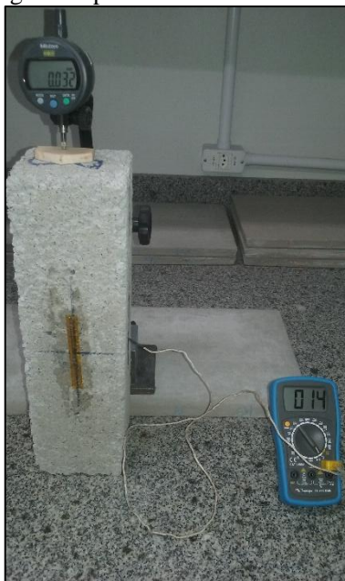
Figura 32 - Corpo-de-prova durante o processo de ganho de temperatura após a retirada do refrigerador, com o multímetro instalado controlando temperatura e o relógio comparador mensurando as expansões.
