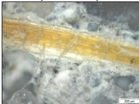
Figura 12 - Microscopia óptica do compósito reforçado com a fibra do bagaço da cana, no sentido paralelo ao comprimento da amostra.
