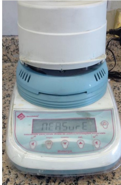
Figura 6 – Determinador de umidade (Quimis) utilizado no ensaio de sólidos totais.
