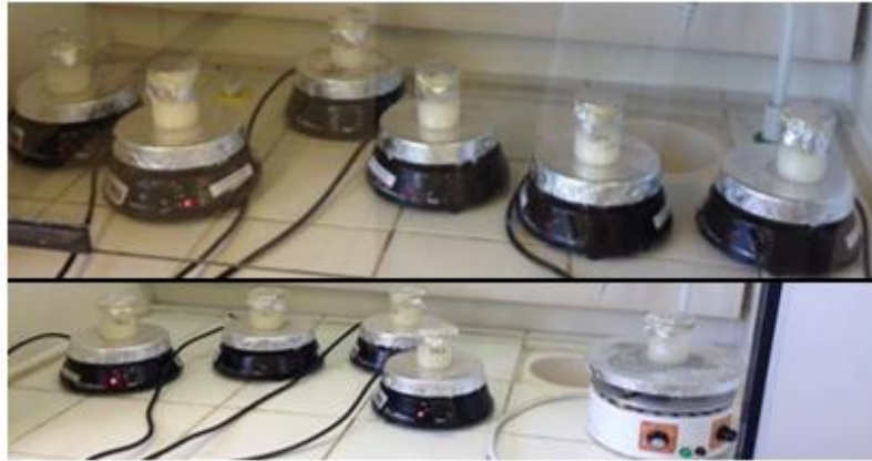
Figura 5.2 – Ensaio de adsorção isotérmica.
