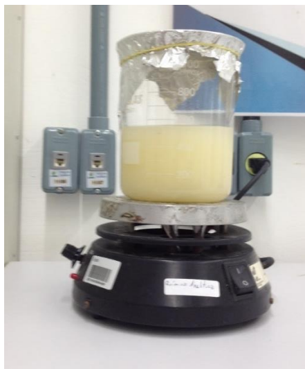
Figura 5.7 – Ensaio de adsorção no efluente, simulando em multiestágios.
