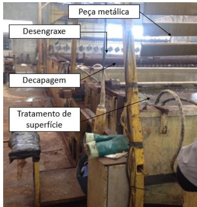
Figura 4.1 – Etapas do processo galvânico da empresa em estudo.
