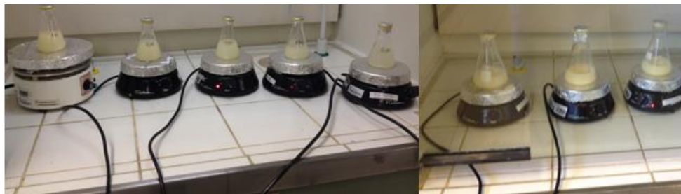
Figura 5.5 – Ensaio de adsorção no efluente, simulando em um único estágio.
