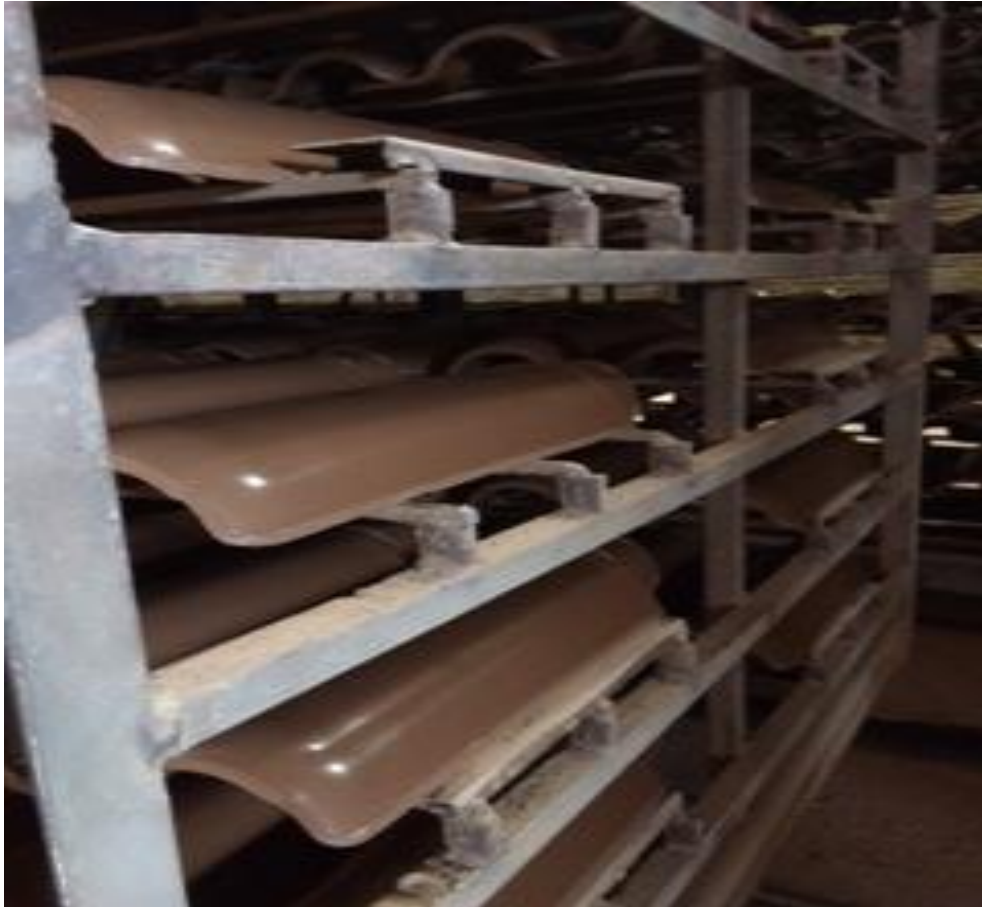
Figura 5 – Falta da almofada de apoio
