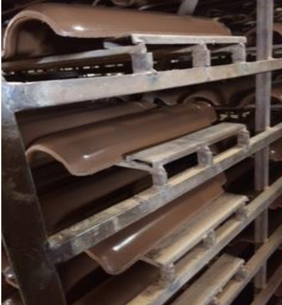
Figura 4 – Telha posicionada fora da almofada
