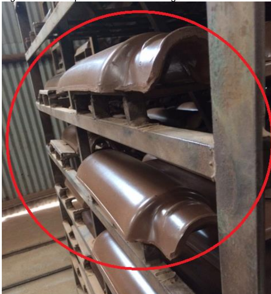
Figura 2 – Telha posicionada fora da vagoneta
