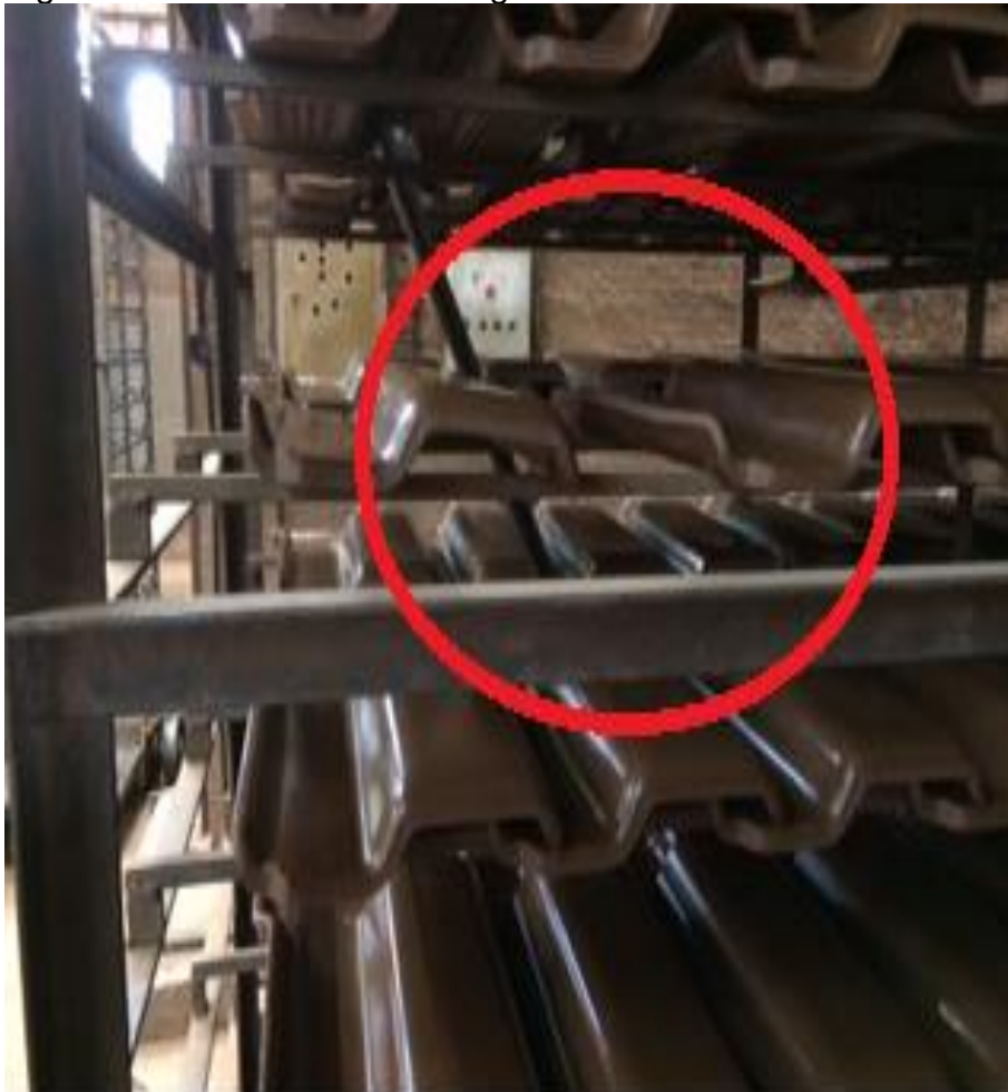
Figura 3 – Falta de telha na vagoneta
