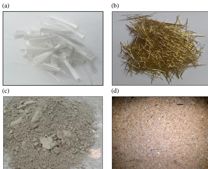
Figura 1. Materiais utilizados na confecção das argamassas: (a) fibra de vidro, (b) microfibra de aço, (c) Cimento CPV ARI, (d) areia média lavada
