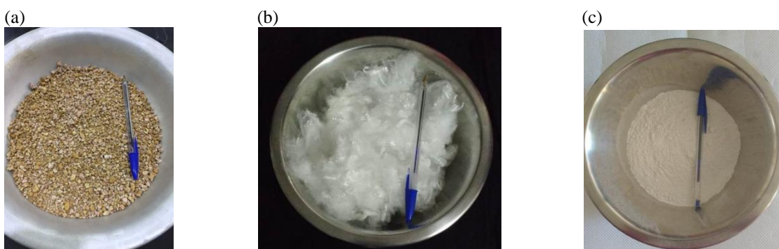
Figura 1. Materiais utilizados: (a) solo de Formação Geológica Palermo, (b) fibra de PET, (c) cal hidratada
