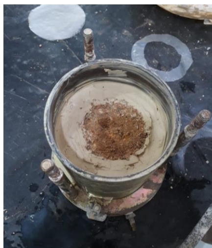
Figura 03: Ensaio de permeabilidade sendo moldado.
