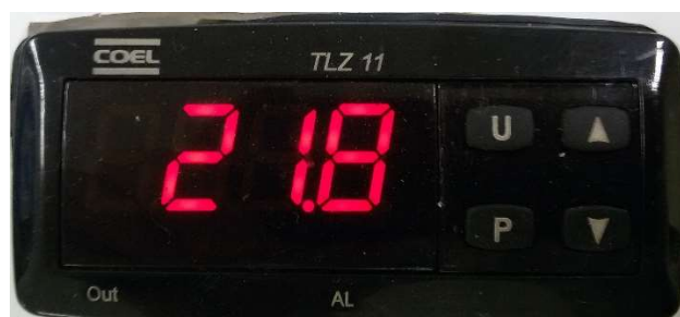
Figura 8 – Controlador de temperatura COEL TZ11 digital
