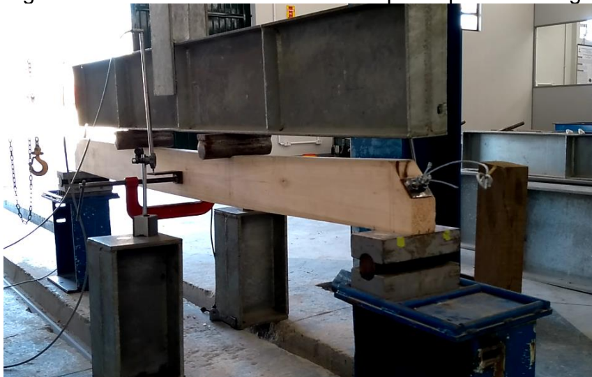
Figura 9 - Ensaio de flexão estática à quatro pontos da viga protendida
