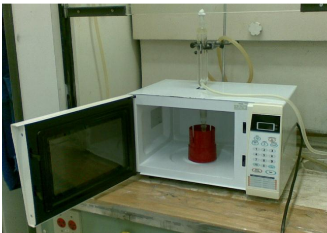
Figura 1: Vista frontal do forno microondas adaptado para síntese orgânica.
