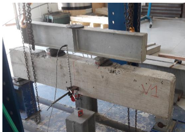
Figura 7 - Ensaio de Flexão a quatro pontos
