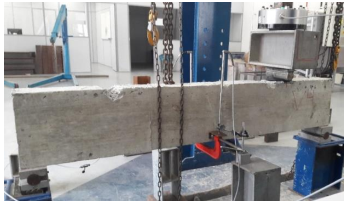
Figura 6 - Ensaio de Cisalhamento
