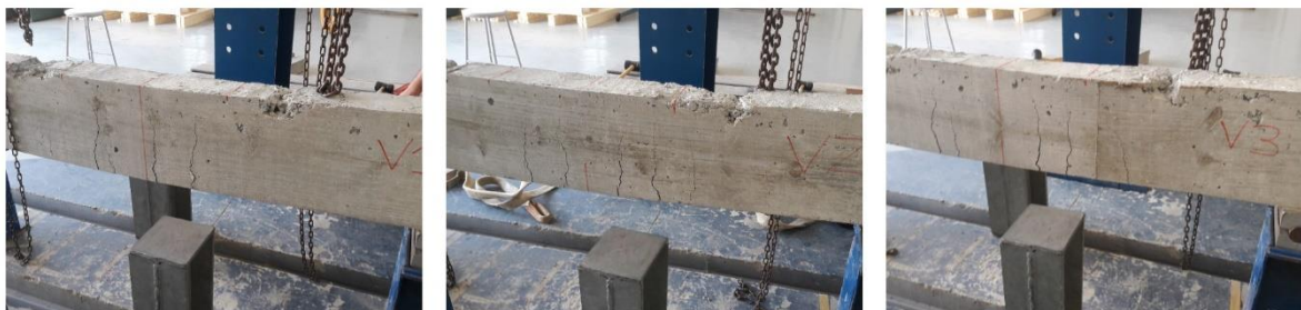
Figura 12 - Fissuras Vigas Maciças com S a cada 10 cm
