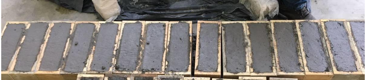
Figura 3 - corpos de prova de concreto de cimento Portland (10x10x35 cm)
