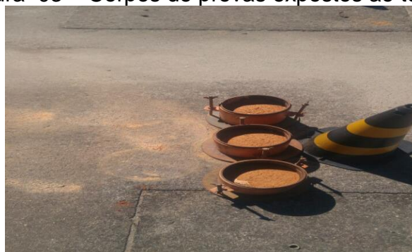
Figura 03 – Corpos de provas expostos ao tempo
