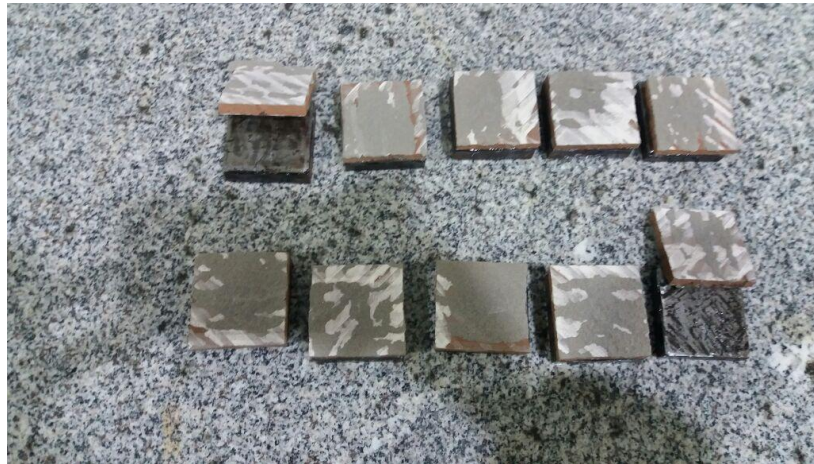
Figura 7 – Rupturas Argamassa aditivada 0,8%
