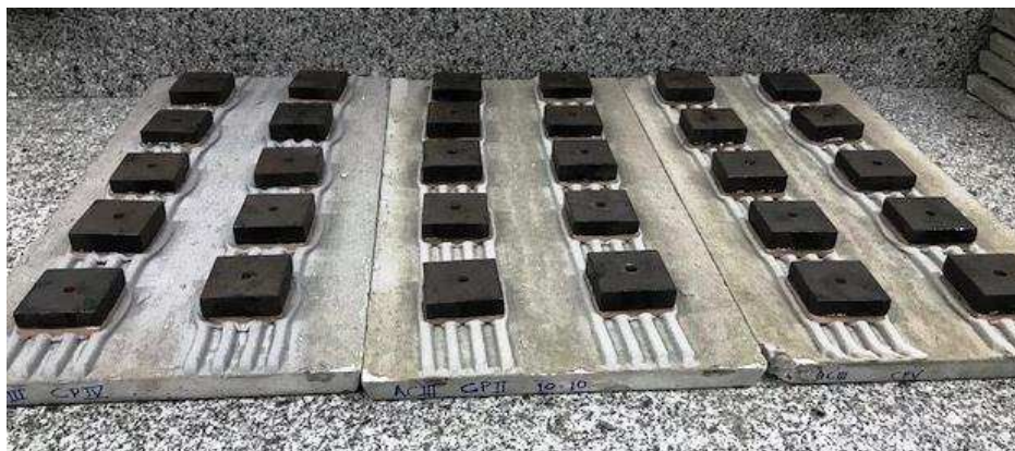
Figura 3: Corpos de prova assentados em substrato padrão
