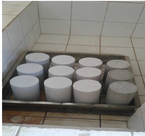
Figura 5: Corpos de prova no tanque com água.
