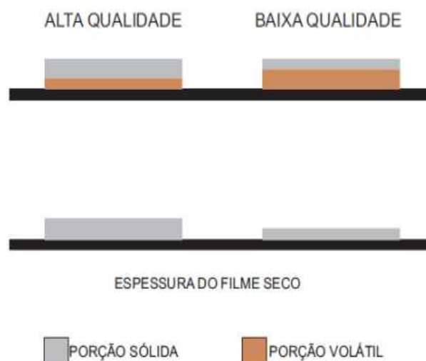
Figura 2: Espessura do filme úmido e seco
