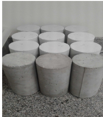
Figura 4: Amostras com a tinta já aplicada.
