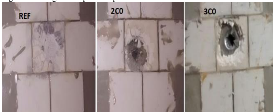
Figura 24: Imagem dos painéis após ensaio balístico.
