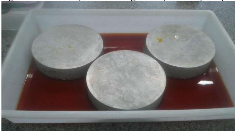
Figura 13: Tratamento químico dos tarugos de Al para formação de pits.
