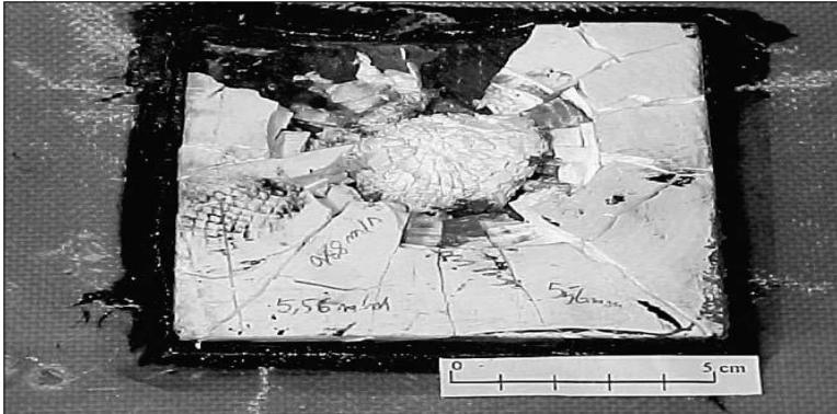
Figura 3: Cone de fraturas em blindagem cerâmica.
