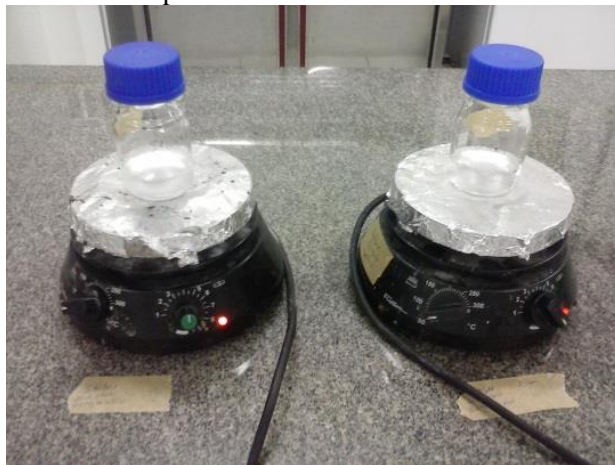
Figura 10 - Imagem do carregamento dos feromônios simultaneamente nas nanopartículas de sílica.
