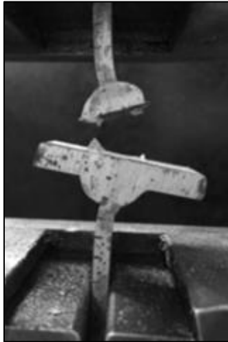
Figura 38 – Ruptura na interface da solda com o metal de base ASTM A36.
